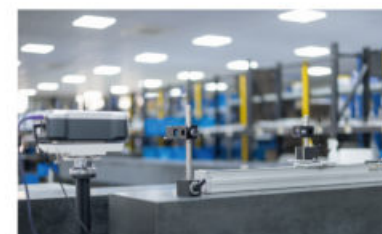
组装成品激光干涉精度检测
